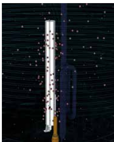
Magnézium anód és aktív anód a tartály korróziójának megelőzésére.
